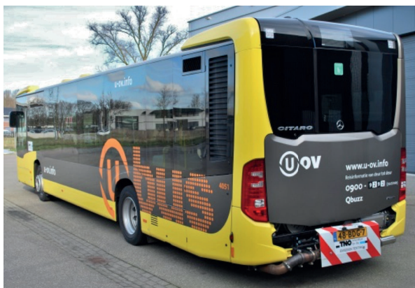
Een PEMS-systeem geïnstalleerd op een Euro VI stadsbus.
