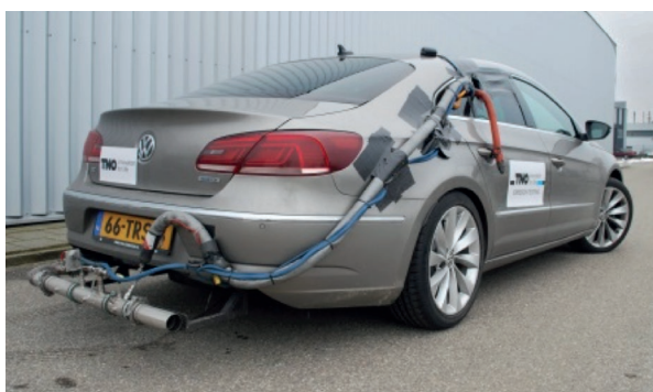
Een PEMS-systeem geïnstalleerd op een Euro 6 personenwagen.
