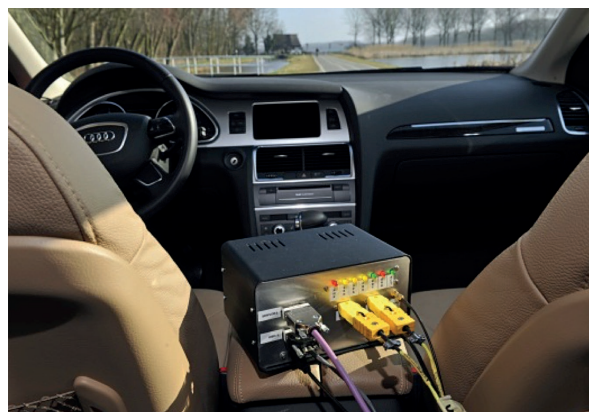
SEMS-apparatuur is compact en neemt in het voertuig weinig ruimte in beslag. De eigenaar kan het voertuig tijdens de metingen gewoon blijven gebruiken.
