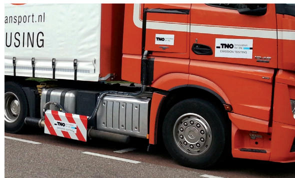
Het PEMS-systeem geïnstalleerd op een Euro VI langeafstands-vrachtwagen.
