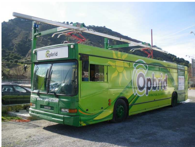
Opbrid: vergelijkbaar concept als Sinautec bus hierboven. In deze bus energie-opslag met hoog-vermogen Li-Ion techniek.
