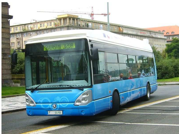
Proton Motors: tri-brid elektrische bus van Proton Motors met Accu's + Supercaps + Methanol brandstofcel. Veldtest bij stadsvervoer in Praag.
